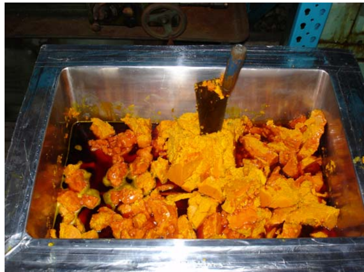
Huile de palme qui fond dans le réservoir
