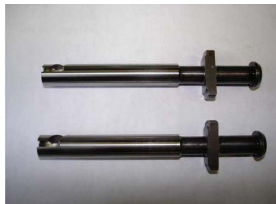
Éléments de pompage A et B
