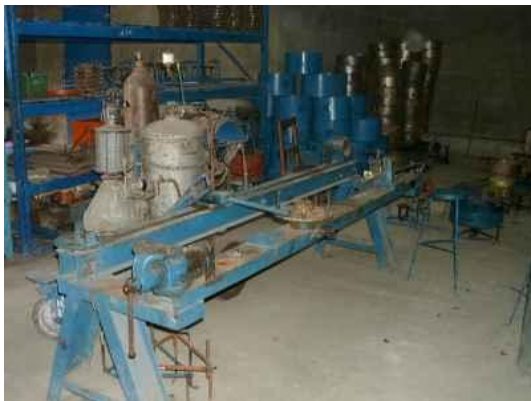
Vue de la table de travail sur laquelle sont fixés les gabarits.
