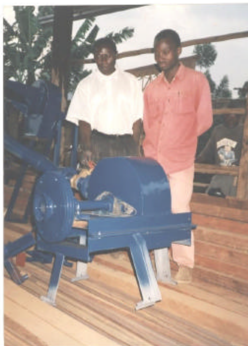
Photo de la turbine de Butembo, dans laquelle sera montée la roue dont la photo suivra
